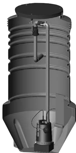
Канализационный колодец с отдельно стоящим насосом
