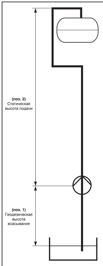
**Рис. 3** Геодезическая высота всасывания и статическая высота подачи
