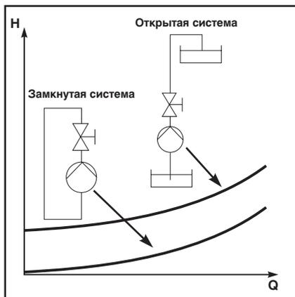
Рис. 12 Характеристики трубопровода
