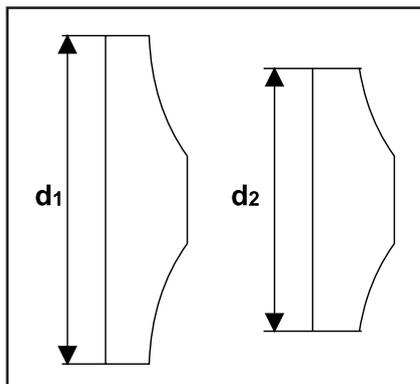
**Рис. 23** Обтачивание рабочего колеса по наружному диаметру
