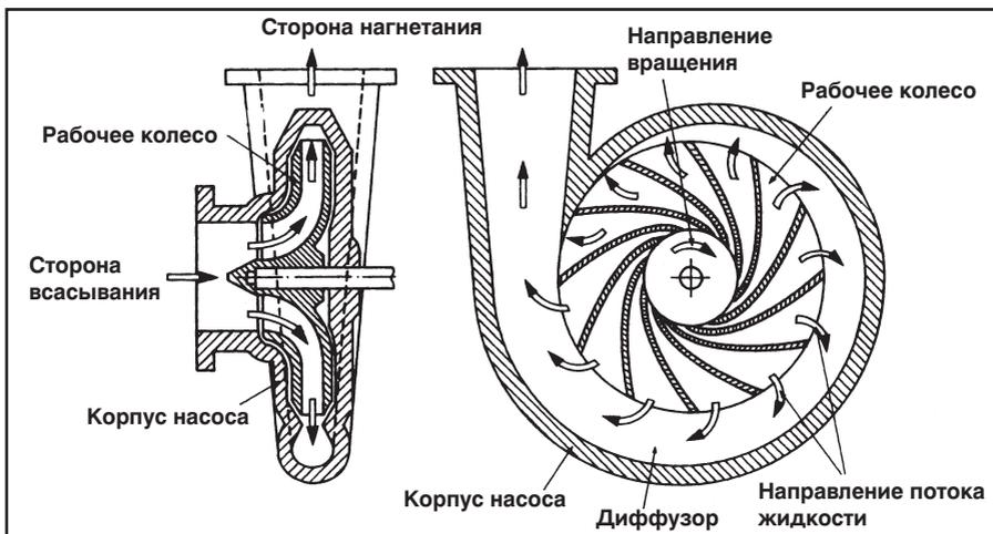
Рис. 9 Конструкция центробежного насоса
