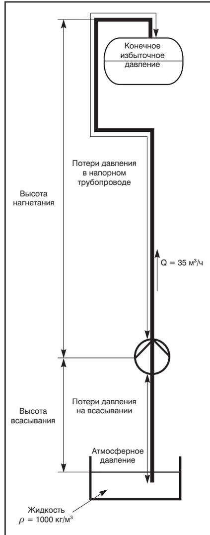
**Рис. 8** Мощность насоса
