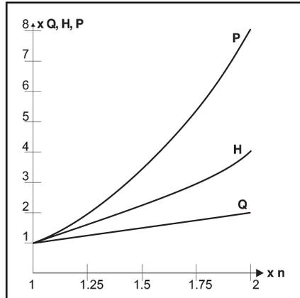
**Рис. 20** Типовые закономерности, связанные частотой вращения рабочего колеса
