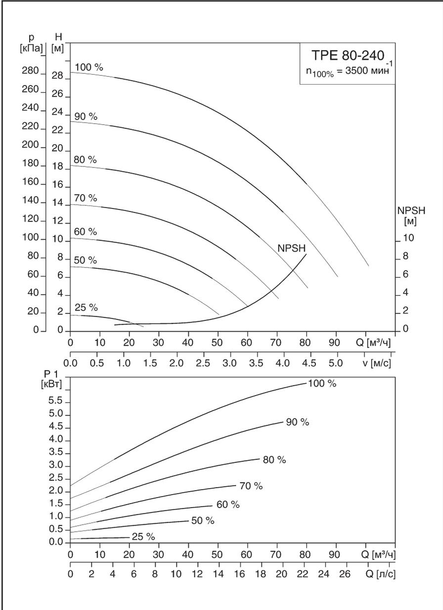
Рис. 29 Регулирование оборотов насоса модели TPE 80-240
