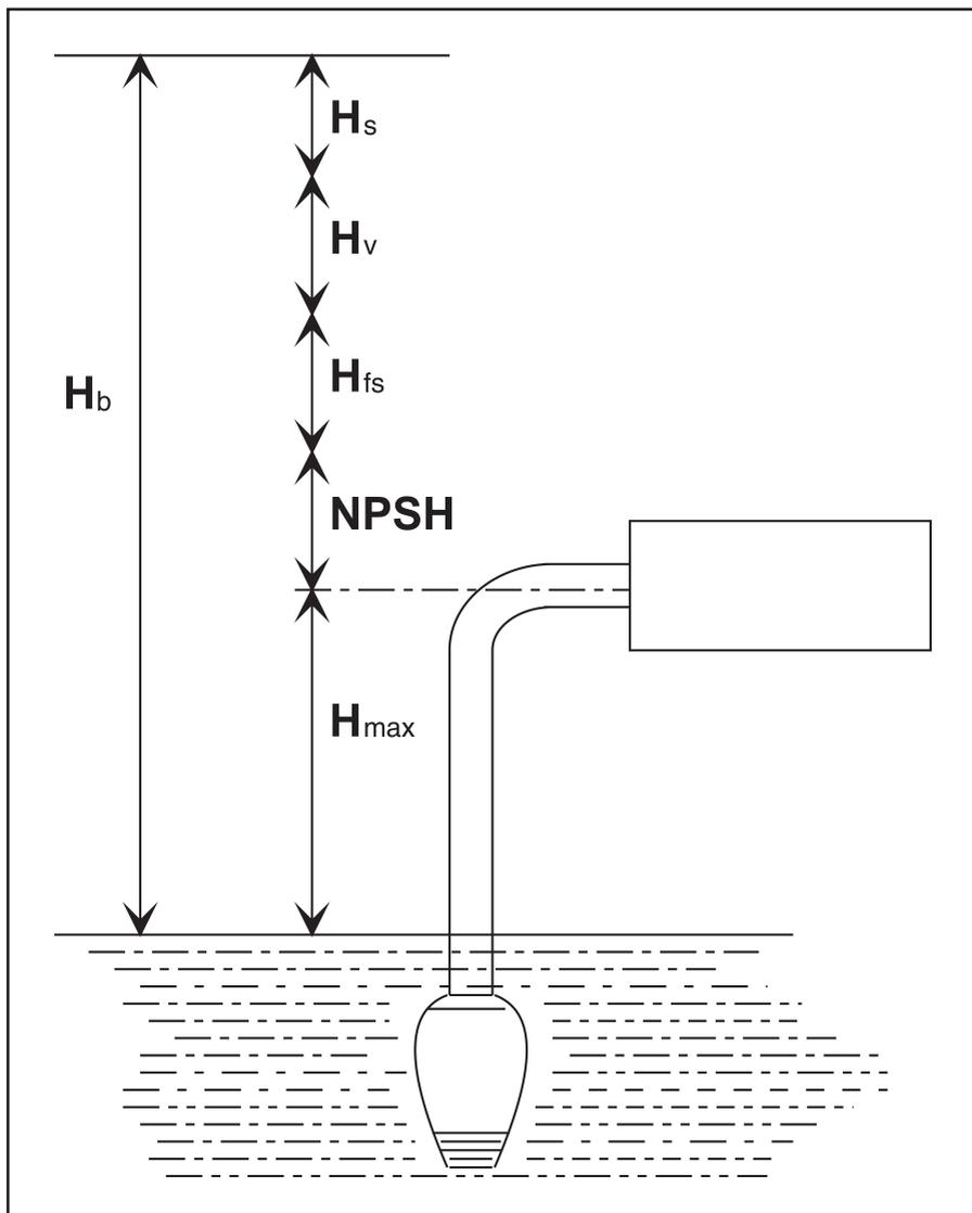
Рис. 33 Максимальная высота всасывания
