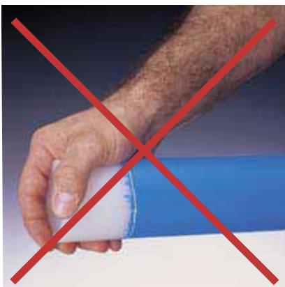
Рис. 59 К зоне сварки нельзя прикасаться руками
