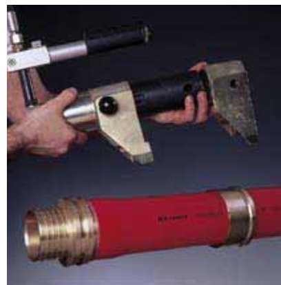
Рис. 20 6. Надеть запрессовочную насадку на цилиндр
