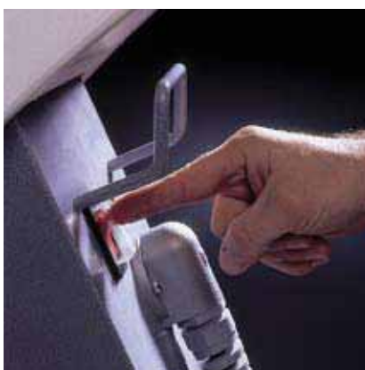
Рис. 65 Главный выключатель сварочного аппарата находится на его обратной стороне
