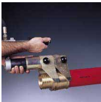
Рис. 22 8. Свести запрессовочные насадки инструмента (тиски) и надвинуть гильзу до ее упора в край фитинга
