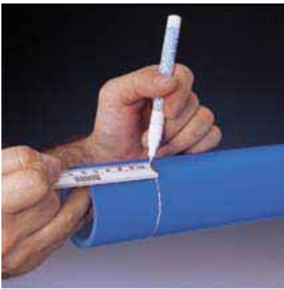
Рис. 53 Для контрастности используйте фломастер другого цвета, чем труба
