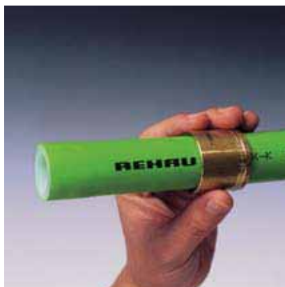
Рис. 8 2. Надеть на трубу подвижную гильзу фаской в сторону фитинга
