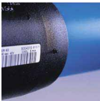
Рис. 66 В приваренных электросварных муфтах индикаторные стержни приподнимутся со стороны обоих концов трубопровода
