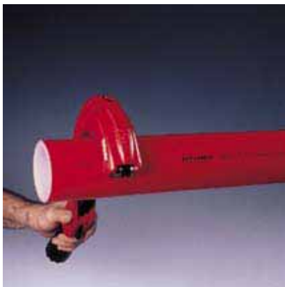
Рис. 15 1. Отрезать трубу по размеру под прямым углом
